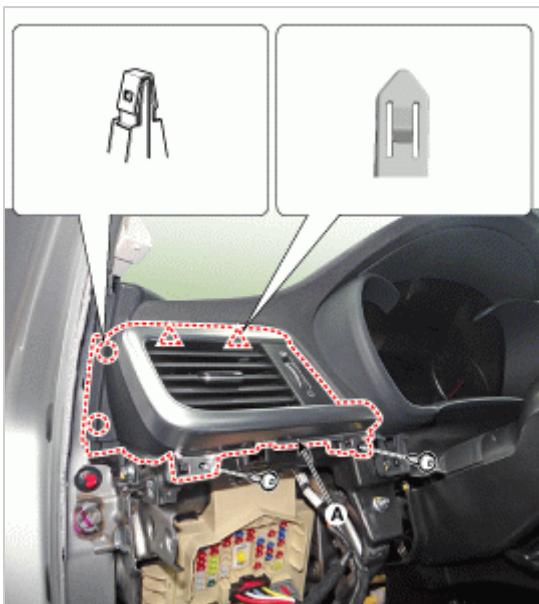
5. 使用拆卸工具拆卸仪表盘装饰板 (A)。
