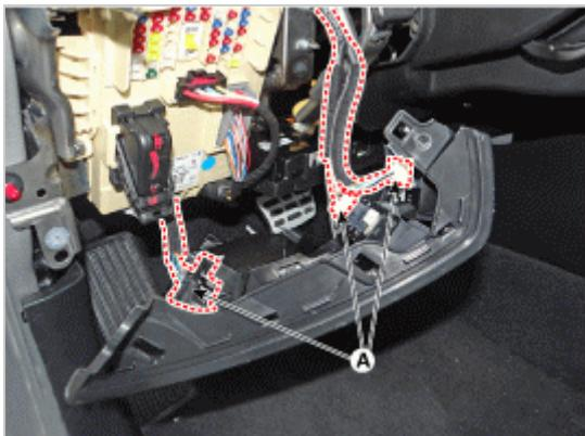
4. 拧下固定螺钉，并拆卸仪表板装饰条[左] (A)。
